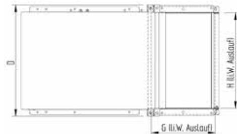
Der pneumatische Auslaufschieber in der Grundversion
