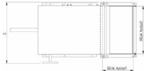
Der Auslaufschieber in der Grundversion mit Handsteuerung
